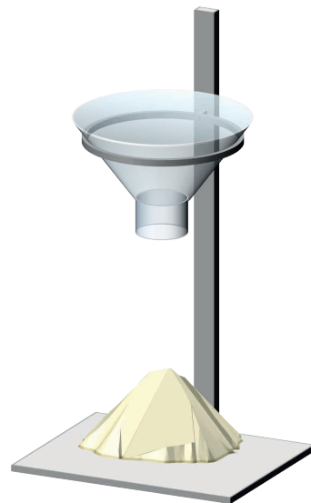
休止角测量根据粉体堆停歇时的角度量化粉体流动性
